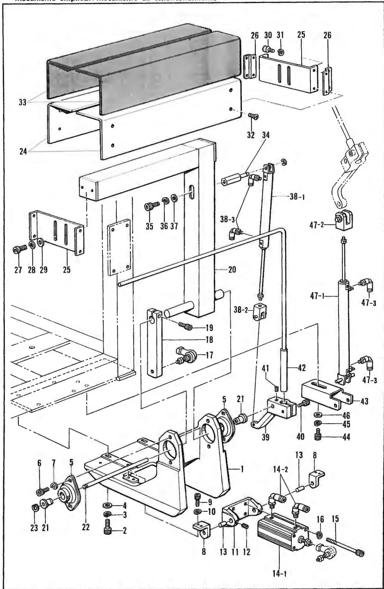
Q. スタッカー関係/Stacker mechanism/Stapelvorrichtung/
