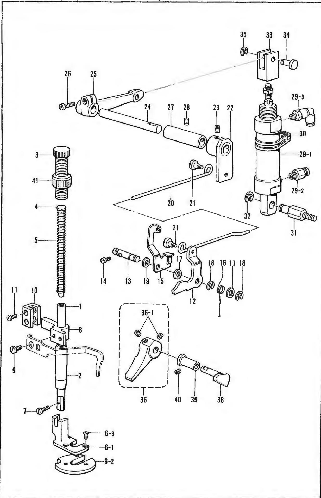
C. 押工関係/Presser foot mechanism/Stoffdrückerfuß/
