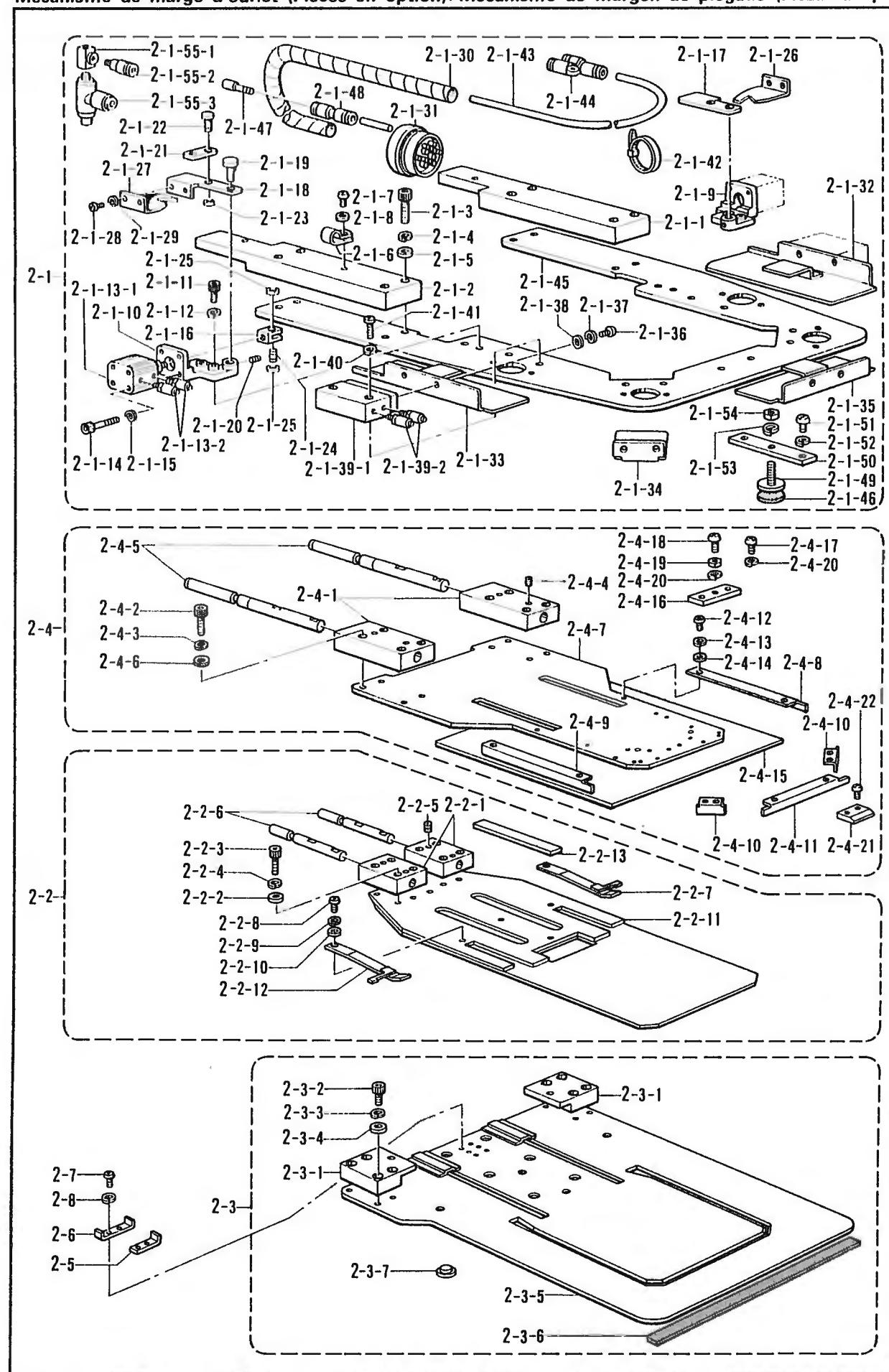
T. 折曲ヶ関係 (特別注文部品) / Folding margin mechanism (Option parts) / Faltungsvorrichtung (Sonderzubehör) /
