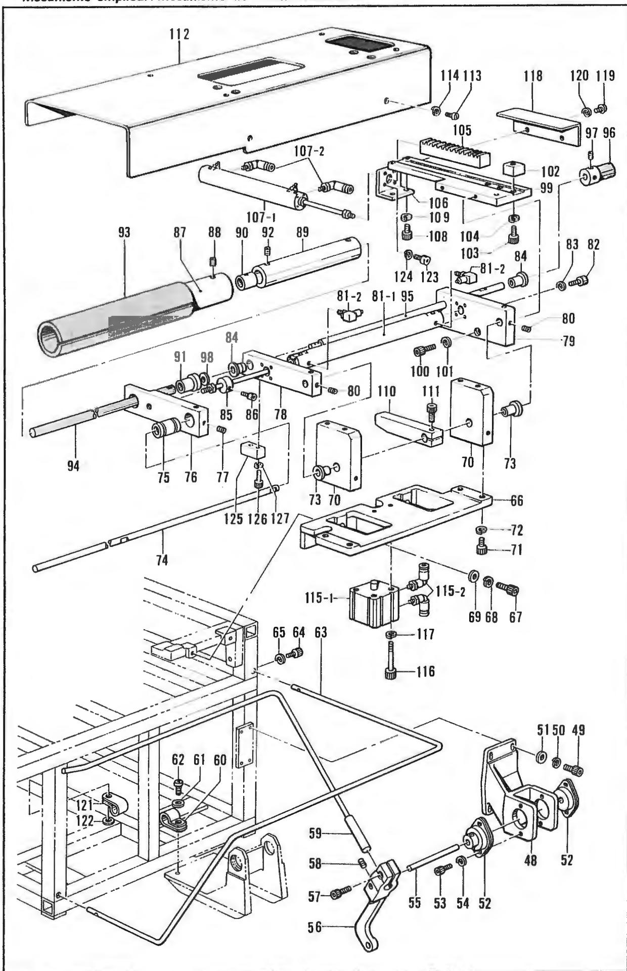
Q. スタッカー関係/Stacker mechanism/Stapelvorrichtung/
