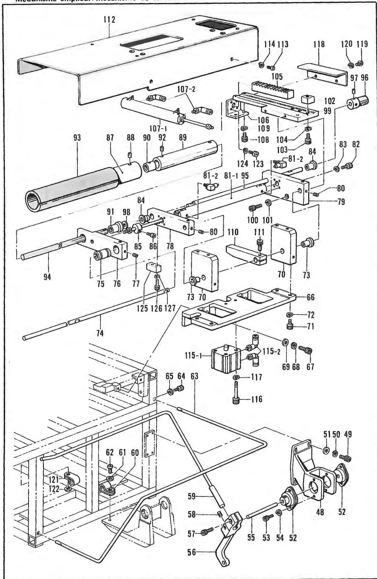
Q. スタッカーケー関係/Stacker mechanism/Stapelvorrichtung/
