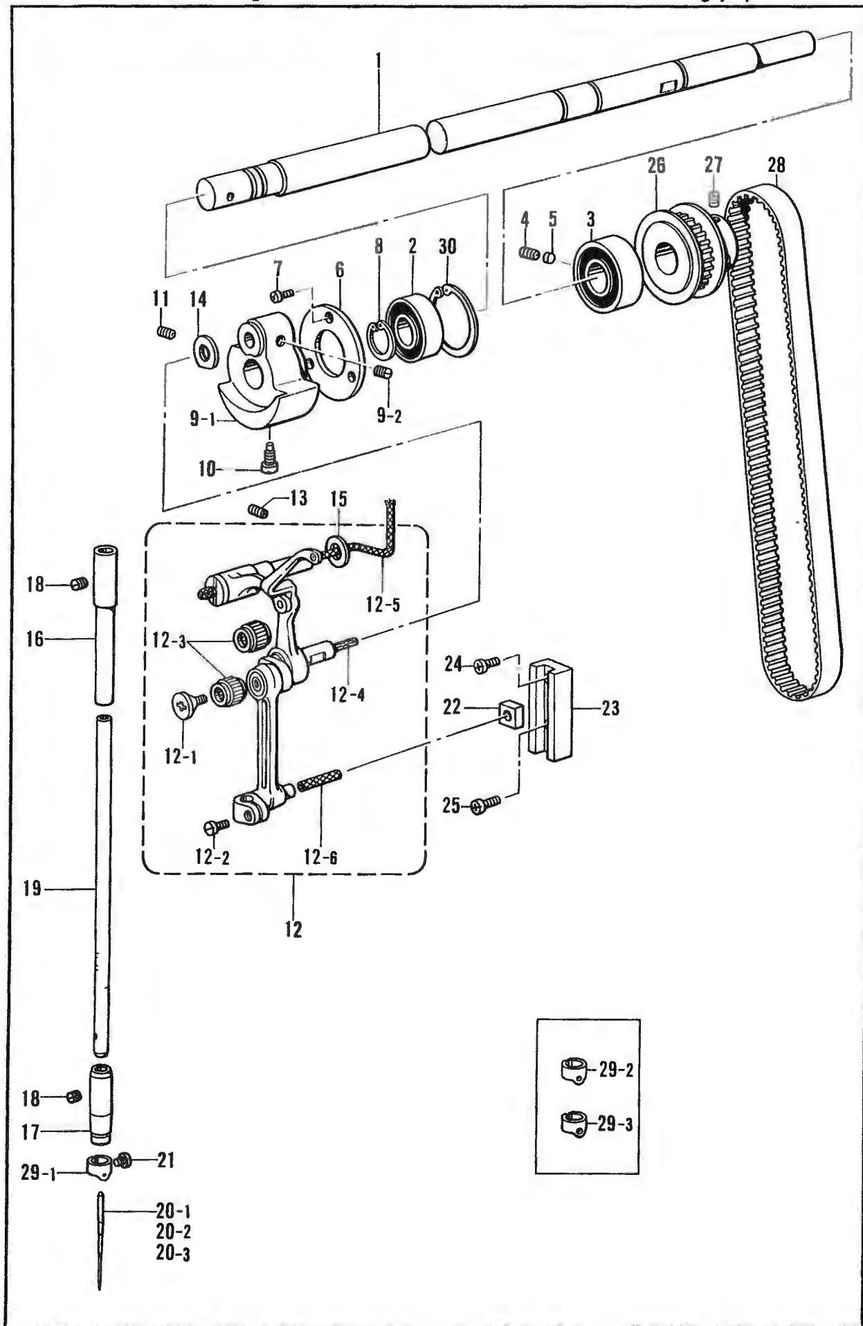
B. 針棒・天秤関係/Needle bar and thread take-up mechanism/Nadelstangen und Fadenabnahmeverrichtung/
