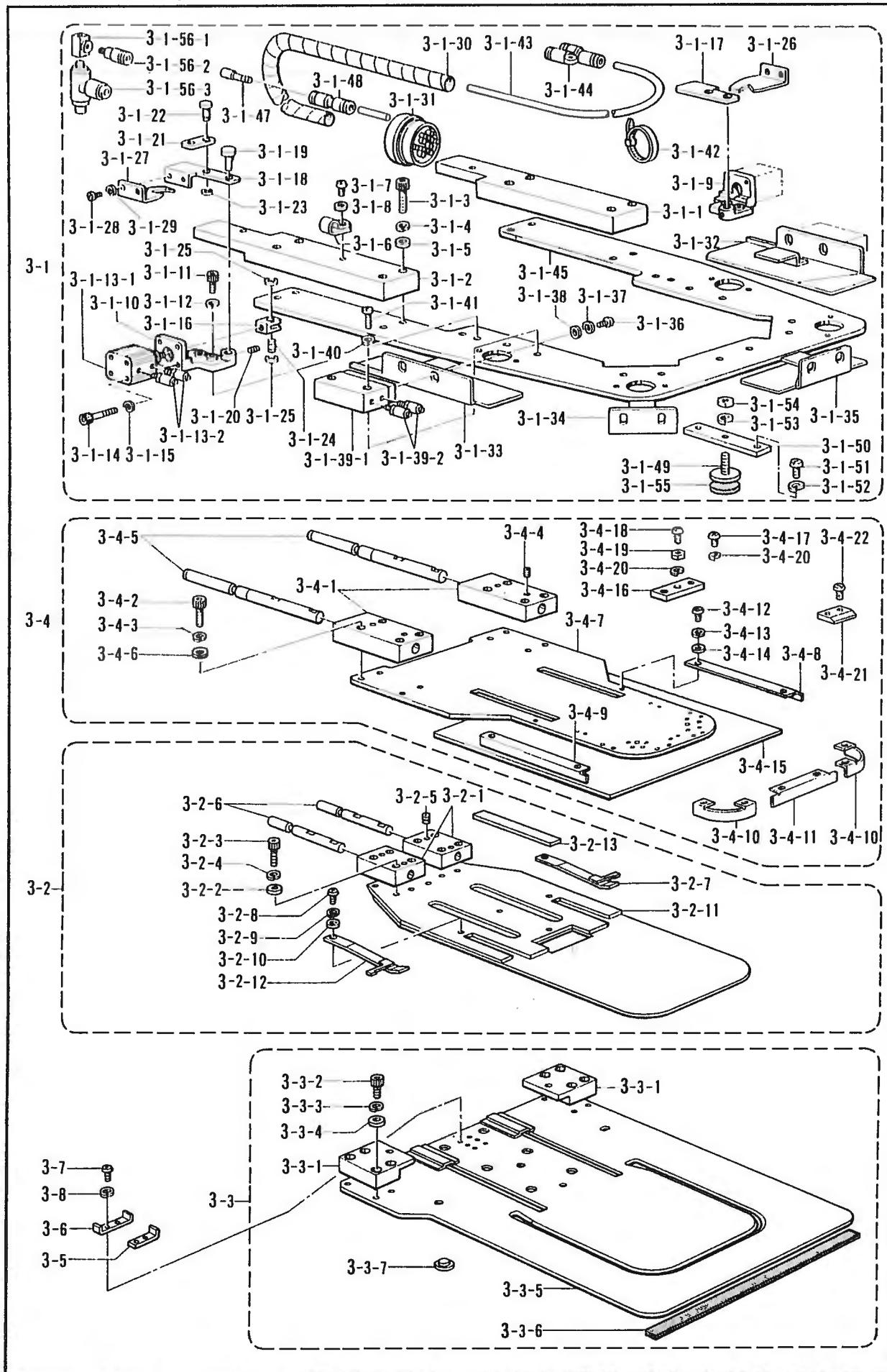
T. 折曲部関係 (特別注文部品) / Folding margin mechanism (Option parts) / Faltungsvorrichtung (Sonderzubehör) /
