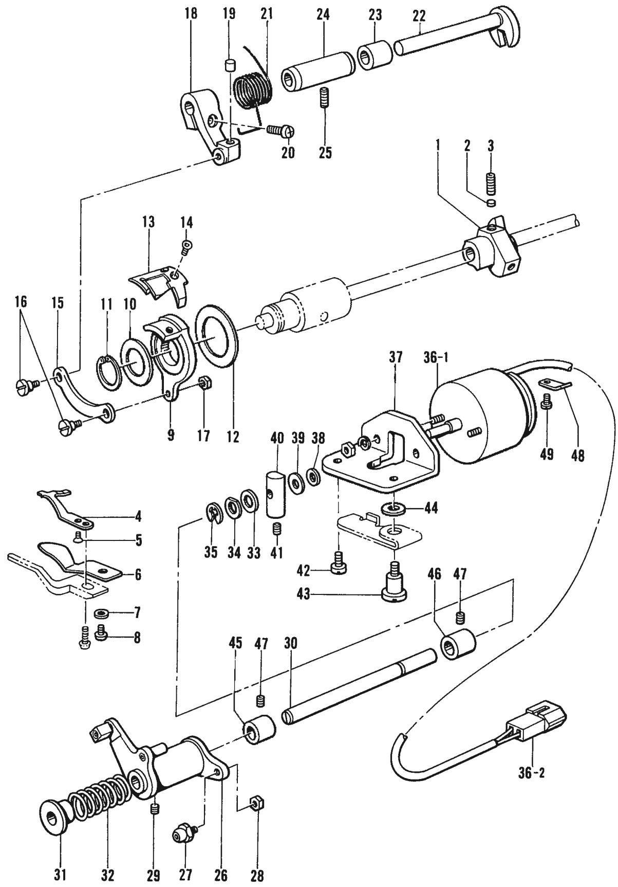
J. 糸切り関係 / Thread trimmer mechanism / Fadenabschneidevorrichtung /
