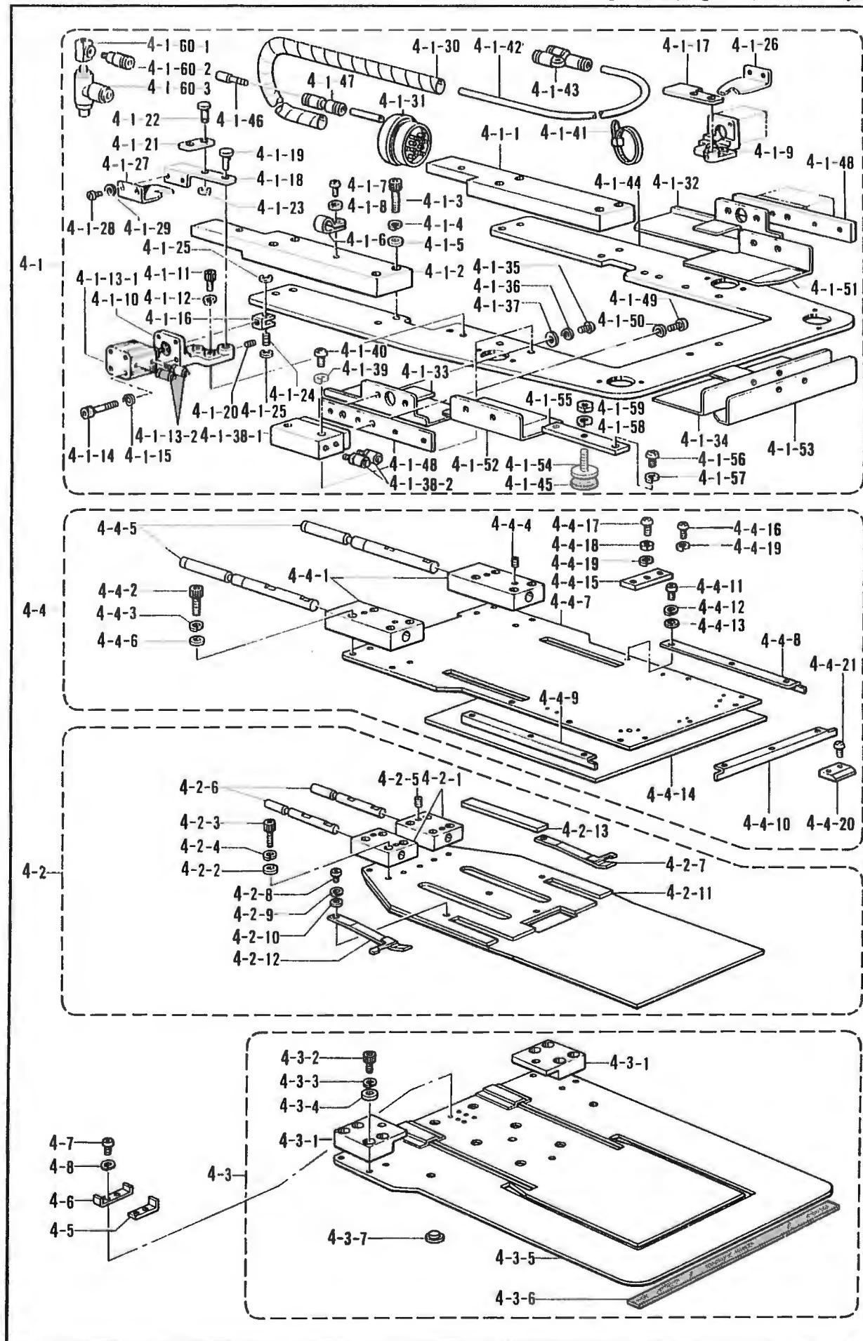
T. 折曲ケ関係 (特別注文部品) / Folding margin mechanism (Option parts) / Faltungsvorrichtung (Sonderzubehör) /
