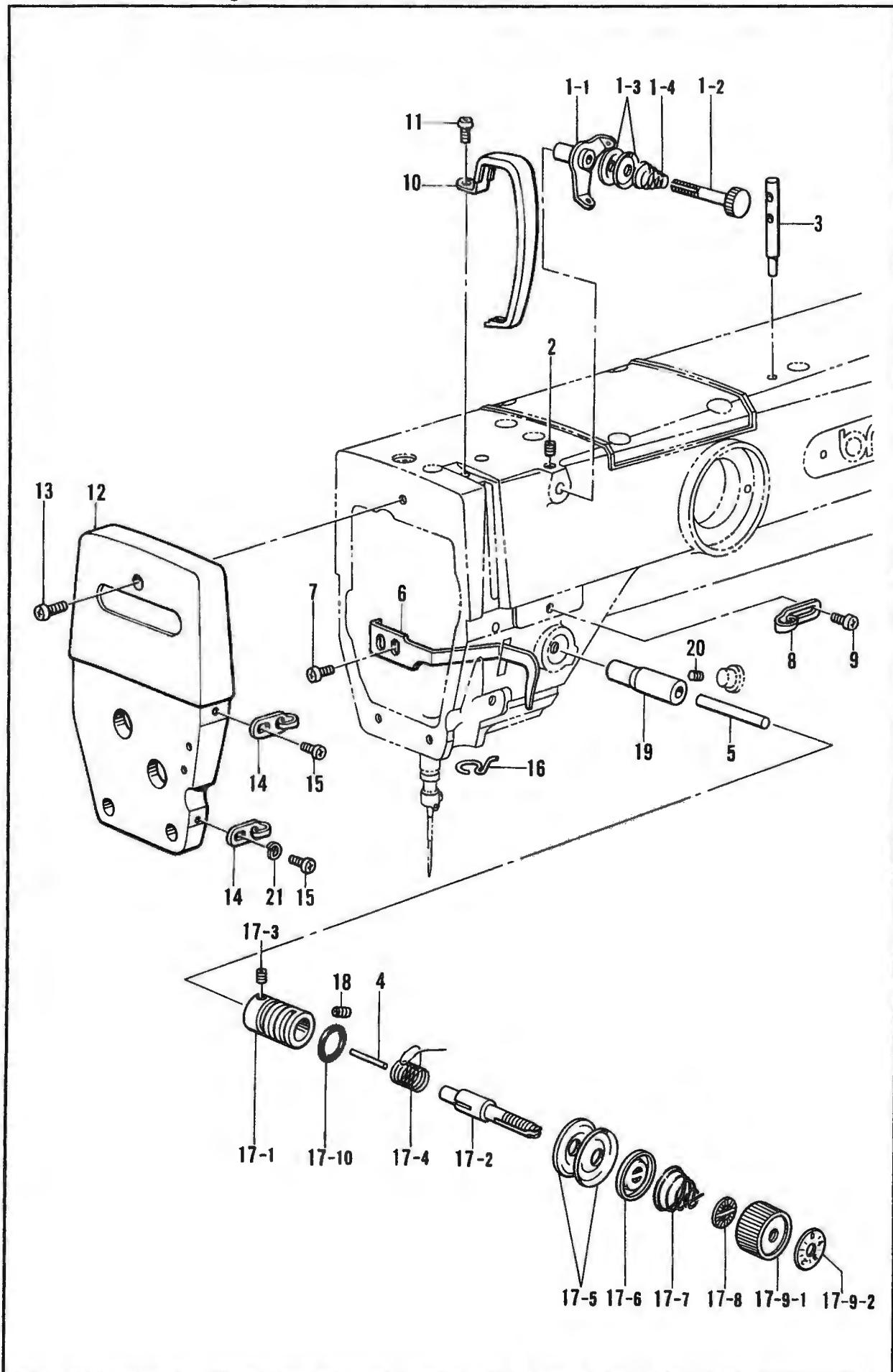
H. 糸通シ関係 / Threading mechanism / Fadenführungs vorrichtung /
