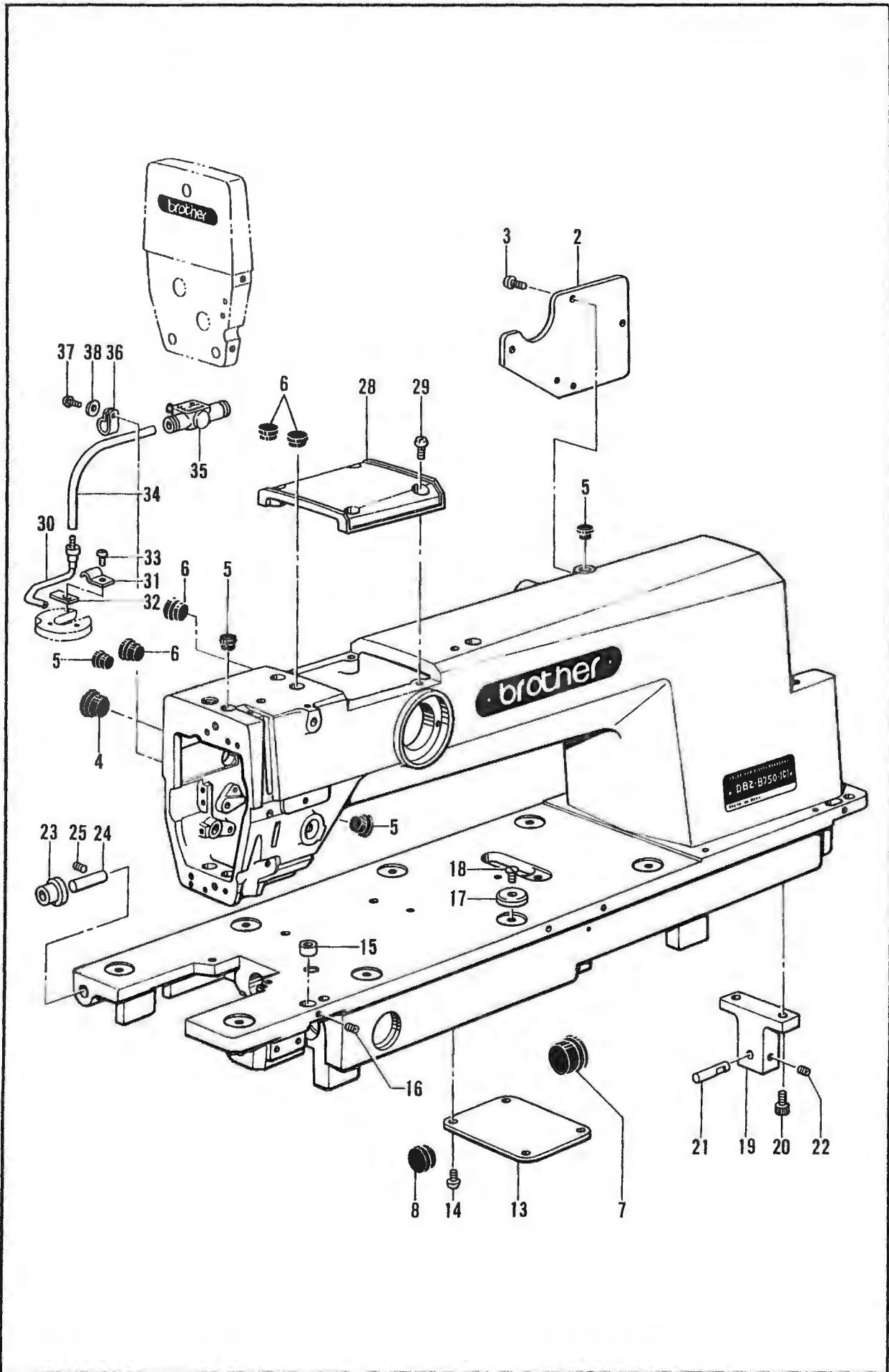
A. 主体関係/Machine body/Maschinengehäuse/
