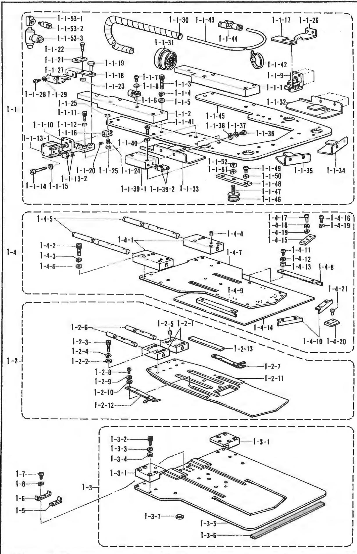
T. 折曲ゲ関係 (特別注文部品) / Folding margin mechanism (Option parts) / Faltungsvorrichtung (Sonderzubehör) /
