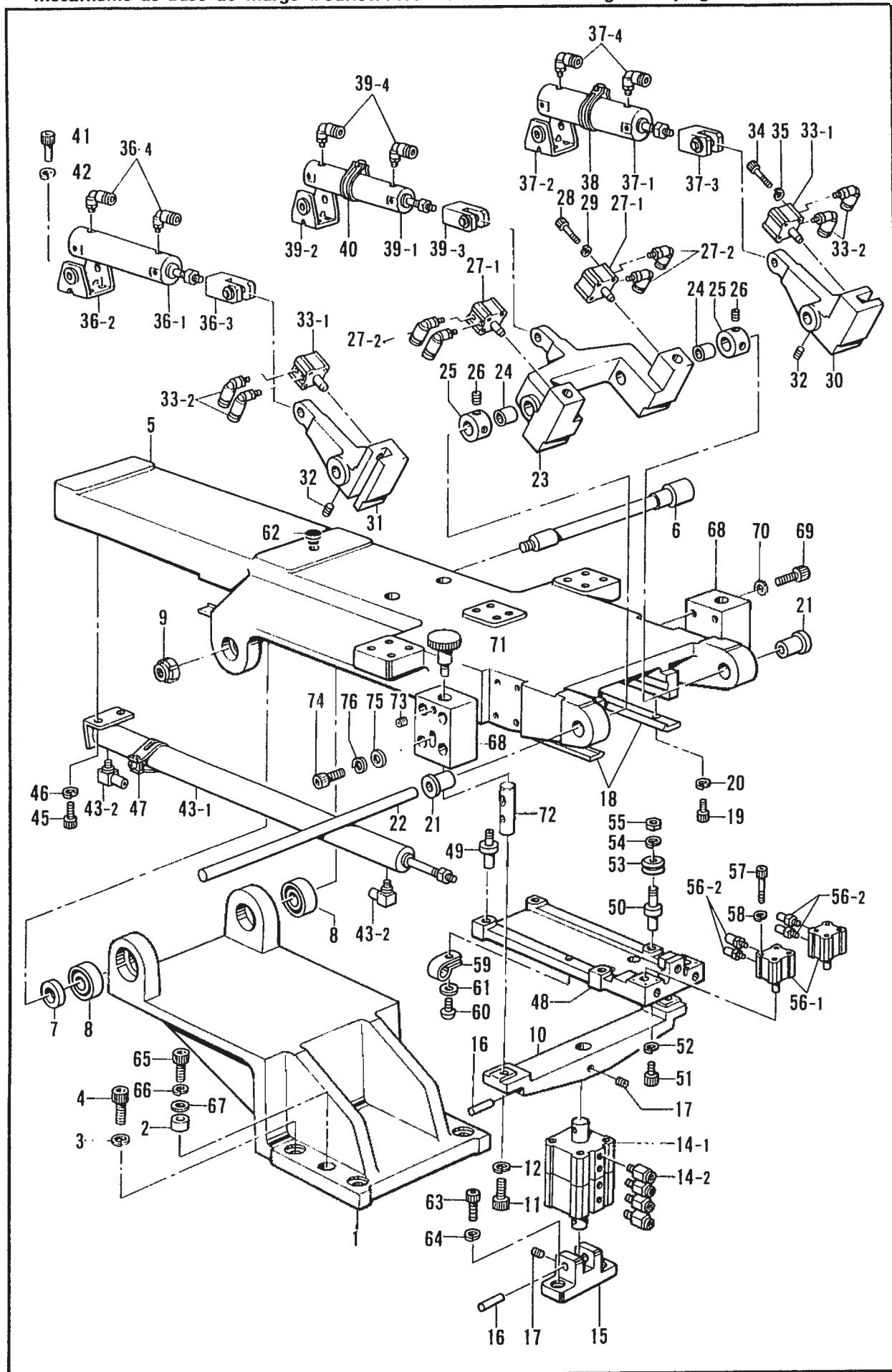
U. 折曲ゲ土台関係 / Folding margin base mechanism / Faltungsvorrichtungsgrundplatte /
